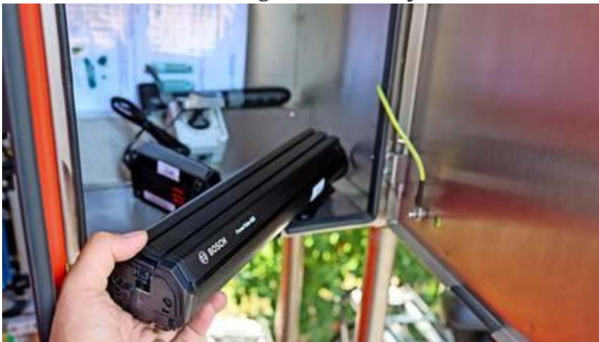
E-Bike-Sharing mit autarker Ladestation in der Wobau-Wohnanlage Weidenweg: Zum Laden werden die Akkus in ein Schließfach platziert.
